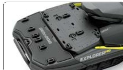
**Extensão da plataforma traseira com segundo ponto de fixação LinQ**
