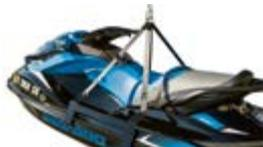
• Levante e posicione com precisão sua moto aquática com um kit de içamento de cintas de náilon e placas de içamento de aço cobertas com vinil.
